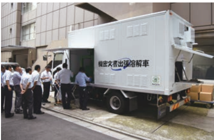
車内で機密文書の溶解処理ができる専用車。
